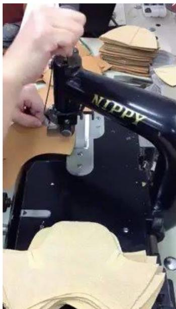
裁断で抜いた革のパーツを縫い合わせるため厚みを、すき機と呼ばれる機械で薄くして縫いやすく調整します。
